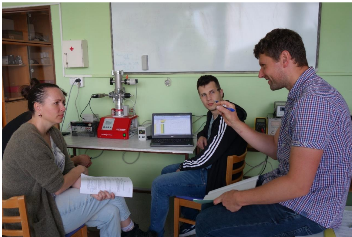
Martin Zejda (vpravo) vysvětluje princip úlohy P3 – Měření čerpací rychlosti turbomolekulární vývěvy metodou stálého tlaku (červen 2023). Aparatura ve vlastnictví školy je doplněna zapůjčeným hmotnostním regulátorem průtoku plynu.
