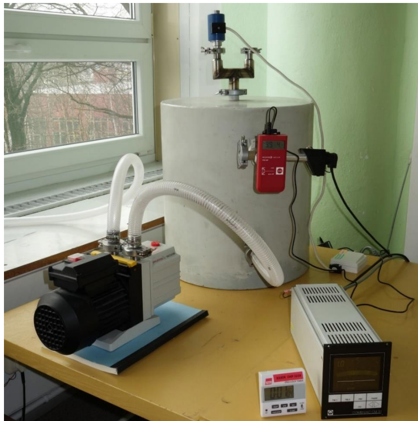
Vakuová aparatura pro generaci jemného vakua
