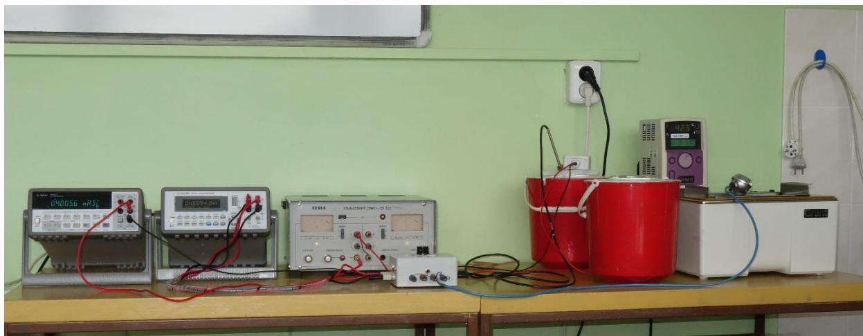
Sestava na kalibraci teplotních snímačů
